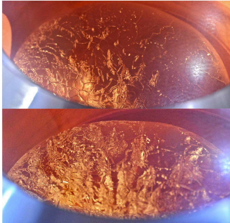
FIGURE 5.27 – Fissures verticales épaisses dans le slab. Vue en plongée, éclairage latéral. En haut : à t_o+17h40 , en bas : à t_o+1j+2h30 de pompage (mêmes instants que les deux dernières photographies de la Figure 5.24).
